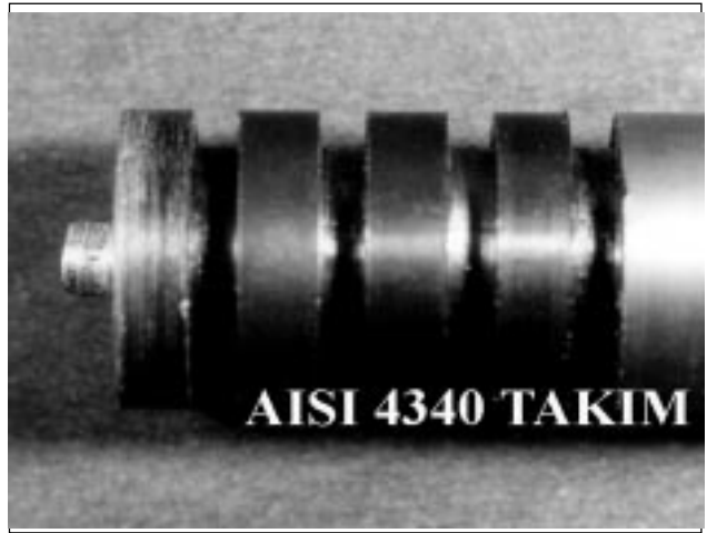
Şekil 2. FSW Yöntemi Uygulanarak Yapılan Deneylerde Kullanılan Takımın Görünümü (19).
